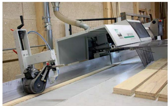
Im Auslauf ist die Kappanlage von Dimter mit einem Rollencodierer ausgestattet, welcher die IPPC-Markierung auf das Holz aufbringt
