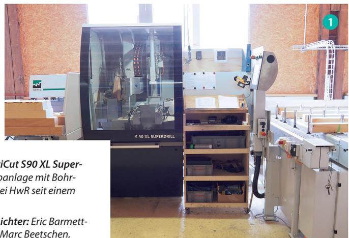
1 Die Dimter OptiCut S90 XL Superdrill – eine Kappanlage mit Bohr- und Fräsaggregat – ist bei HwR seit einem Jahr im Einsatz
