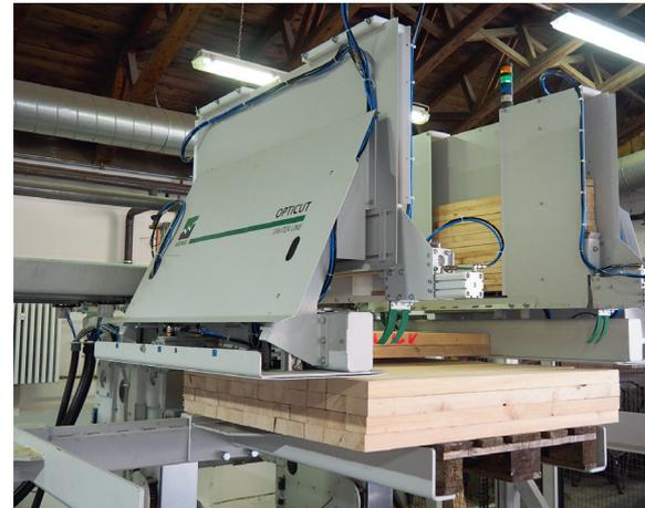
Der OptiCut-Stacker 3000 P stapelt bis 1400 mm Höhe und 3,16 m Länge
