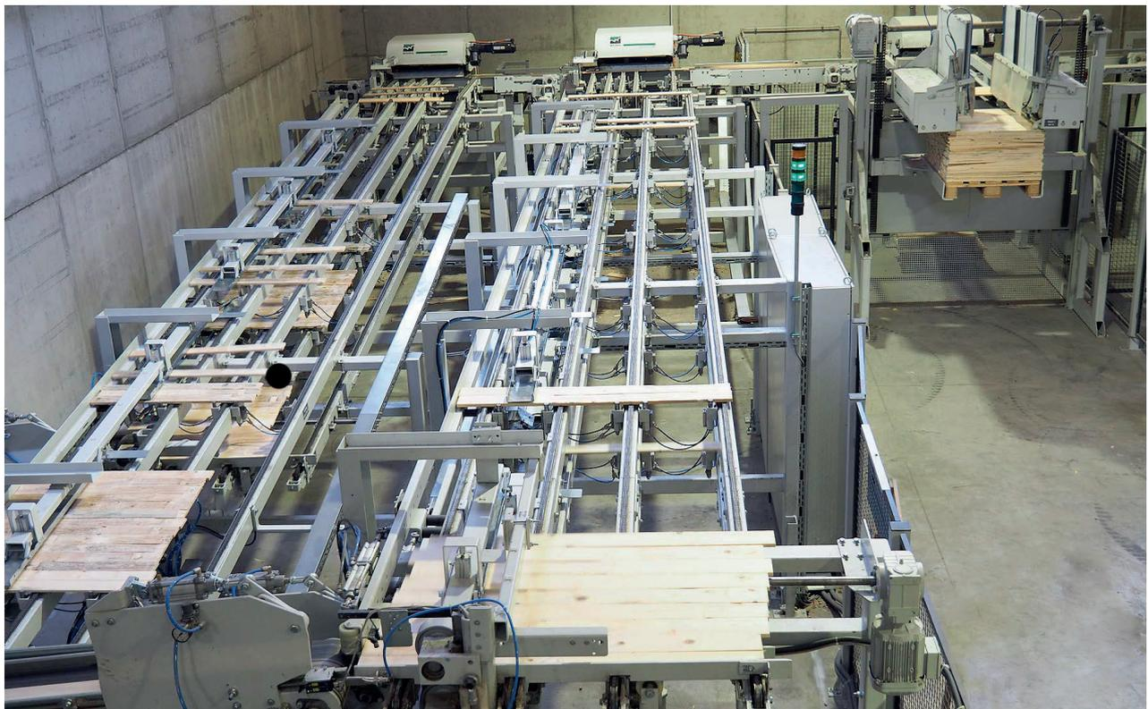
„Verteilerstation“: hinten rechts eine der beiden Dimter-Stapelautomaten OptiCut Stacker ST 10, links daneben die zwei Paddelauswerfer sowie die Zuteilförderer auf zwei Ebenen, vorne links geht es zur Corali (s. nächstes Bild re. unten)
