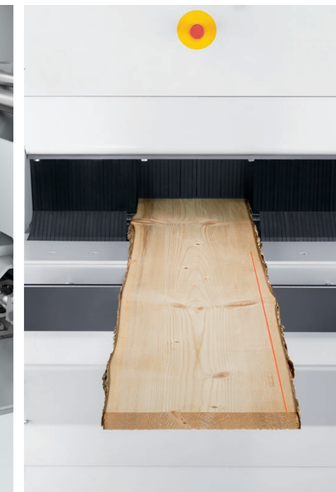
Laser zur Schnittanzeige: sehen, was gesägt wird
