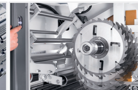
Elektrische Höhenverstellung der Sägewelle: hoher Bedienkomfort
