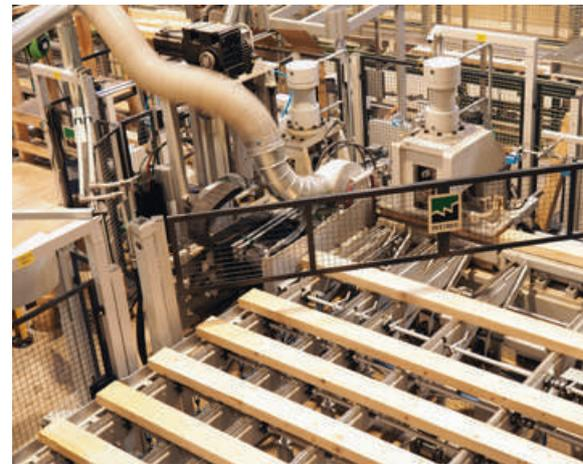
... die anschließend im Quertransport der PowerJoint 8 von Weing Grecon zugeführt wird - im Bild unten der Fräs- und Beleimvorgang
